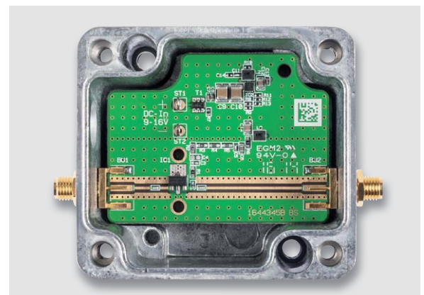
Bild 8: SMA-Buchsen positioniert und auf der Oberseite angeheftet
