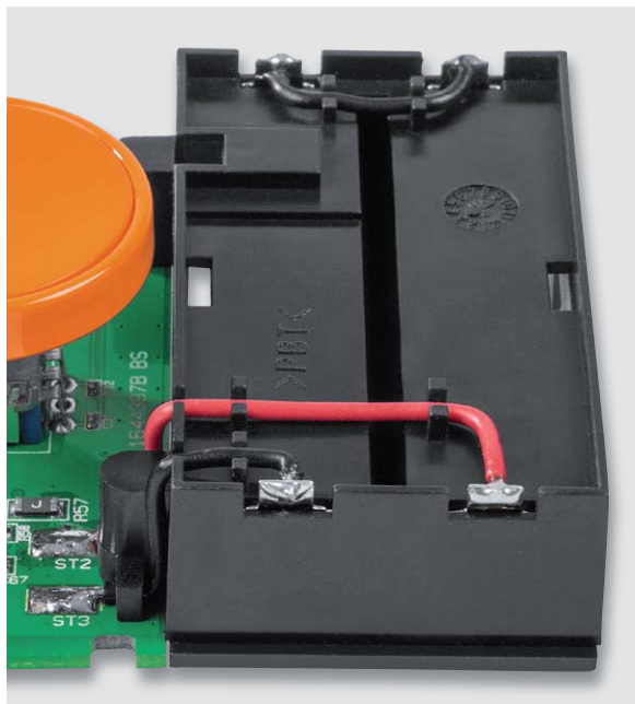
Bild 13: Montage- und Verdrahtungsdetail für die Montage des Batteriefachs auf der Platine
