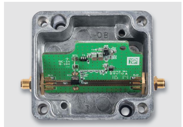
Bild 7: Leiterplatte senkrecht in die SMA-Buchsen eingeschoben
