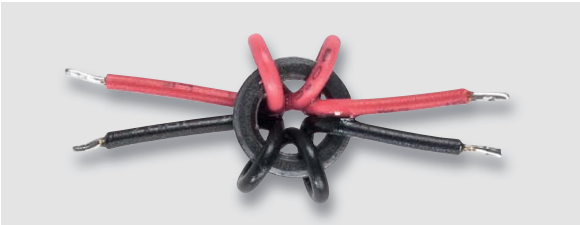
Bild 11: Fertig gewickelte stromkompensierte Ringkerndrossel
